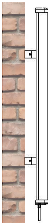
Montaggio a parete con staffe SAN/PL da palo (consigliate per tratte di protezione lungo parete)
